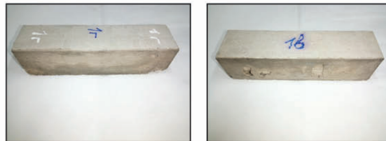
Рис.2. Дефекты изготовления образцов в стандартной форме: а) отсутствие материала в нижних углах; б) раковины.
