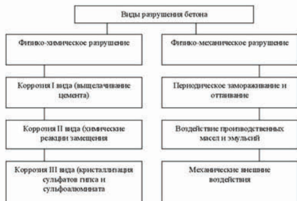
Рис. 2 – Классификация видов разрушений бетона
