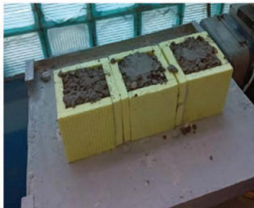
Рис.1б – бетонирование в несъемной опалубке
