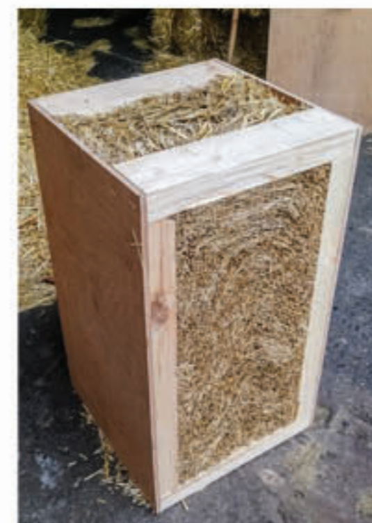
Экопанели «ЭКОБУД» из ржаной пшеницы
