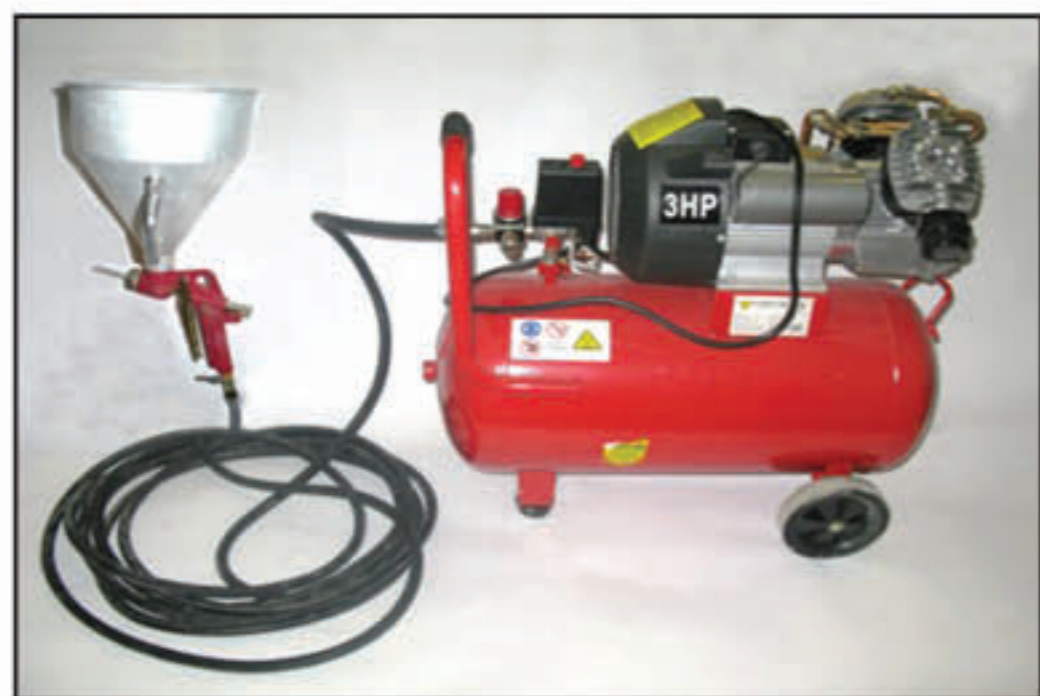
Рис.3. Мобильная установка торкретирования
